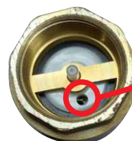
Válvula de retenção furada
